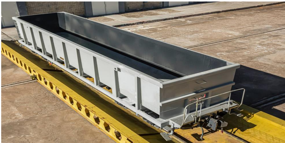
واگن لبه بلند و لبه کوتاه: مناسب برای حمل کالاهای حمل آهن آلات و مصالح ساختمانی
