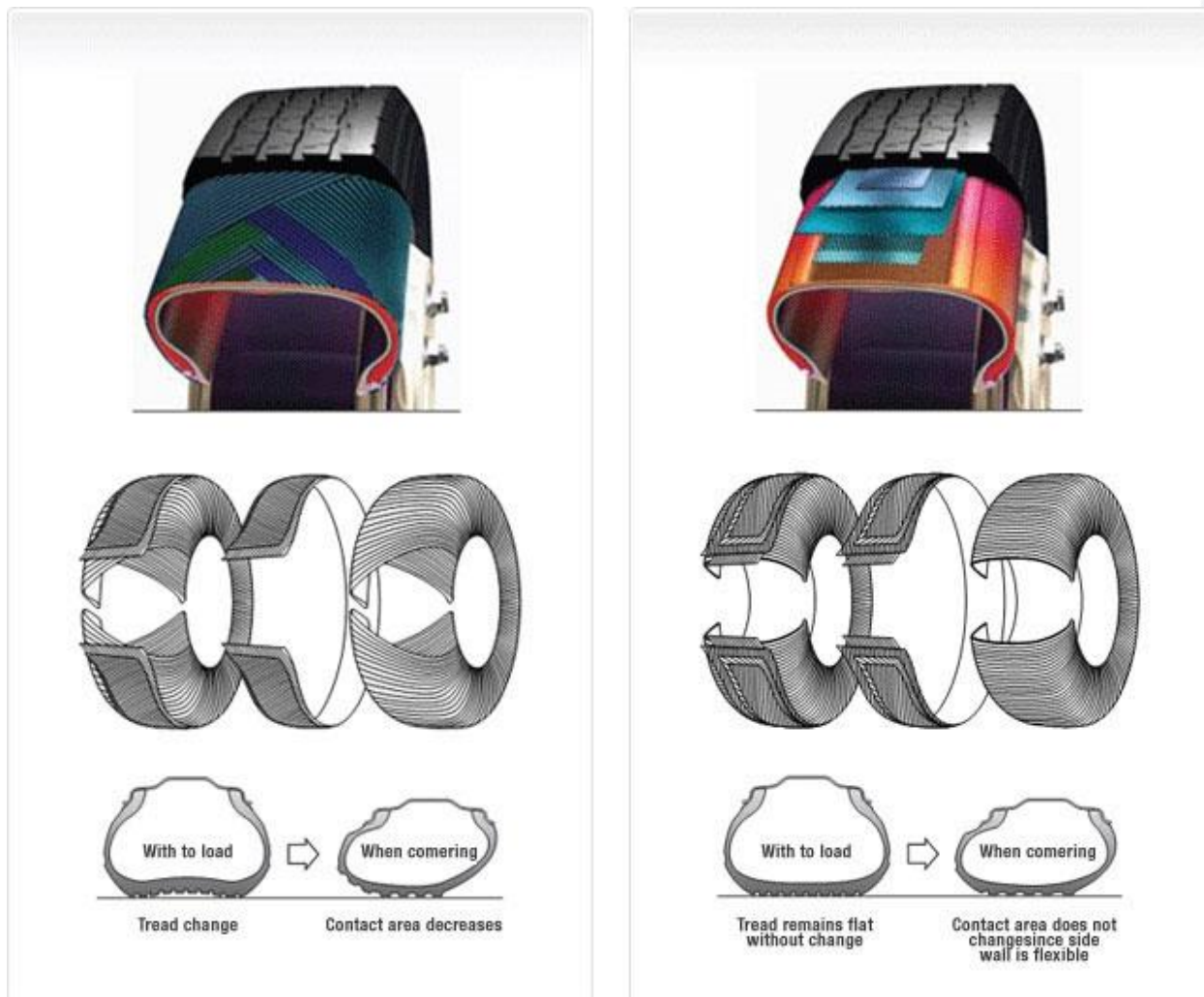
مقایسه نحوه قرار گرفتن نخها در ساختار تایر بایاس (سمت چپ) و تایر رادیال (سمت راست)
